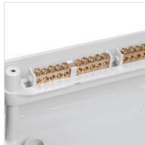
Съемный держатель шин N и PE можно устанавливать как сверху, так и внизу корпуса на специальные крепления. Сами же шины N и PE устанавливаются на съемный держатель простым защелкиванием в посадочные места.
