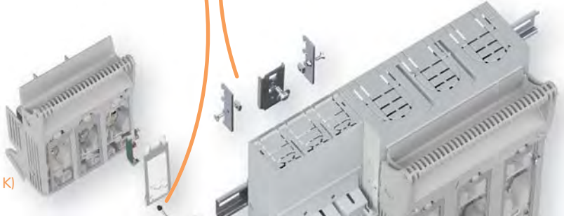
→ Роз'єднувачі KVL-00 та KVL-1 мають можливість монтажу на шину TH-35 за допомогою адаптера, а застосування довгих захисних кришок дозволяє встановлювати KVL-00 та KVL-1 в одну лінійку
