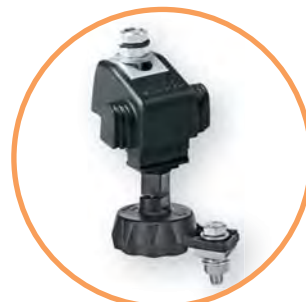
→ Затискач, тип "S" з проколом ізоляції з одного боку, обладнаний болтом із зривною голівкою і можливістю встановлення під напругою, 10 - 150 mm 2
